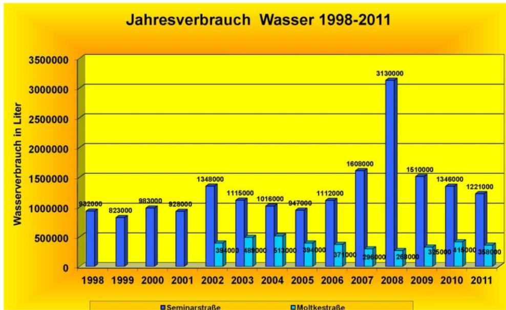
Der hohe Verbrauch im Jahr 2008 ist auf einen Wasserrohrbruch im Außenbereich zurückzuführen, den wir bei unseren Routineablesungen entdeckten und der mit einem Wasserverlust von ca. 1.400.000 Litern verbunden war.
